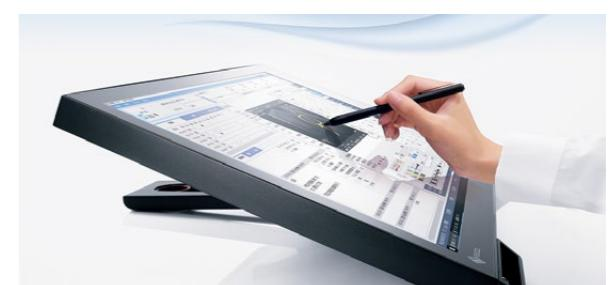
MS236WT 显示器配备了防误触功能, 即使您的手直接放在屏幕上, 也不会导致任何意外的触控输入, 确保您可以专注于书写。防误触最小激活面积为 2 × 2 厘米。
